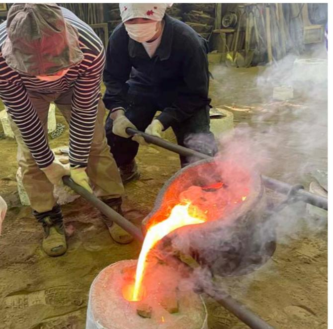
1100°C以上で溶解した銅合金を鋳型に流し込みます。
