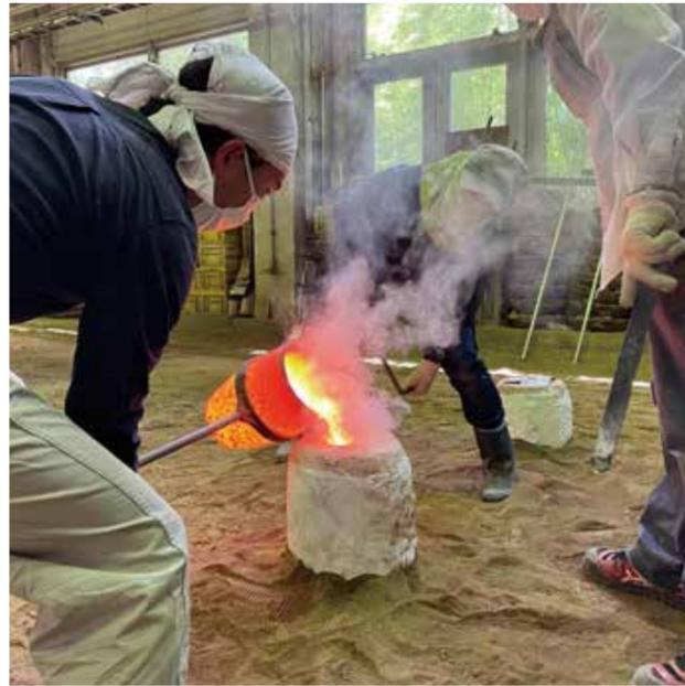
1080°C前後の溶解温度で銅合金を流し込みます。その場面を「吹き」と言います。
