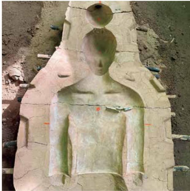
石膏原形から雌型として抜き取り、耐火度のある土の鑄型に金属を流し込みます。
