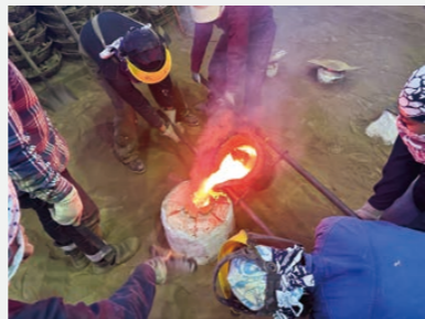
1080℃前後の溶解温度で銅合金を流し込みます。その場面を「吹き」と言います。
